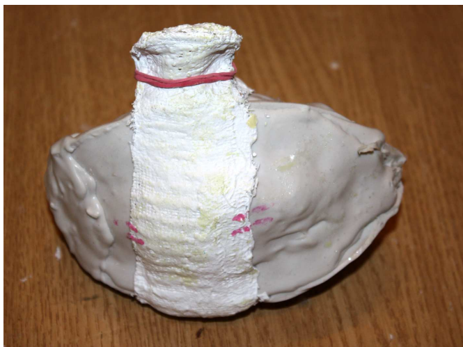
Ha szükség volt rá, gipszes gézzel erősítettük meg az öntés előtt.
