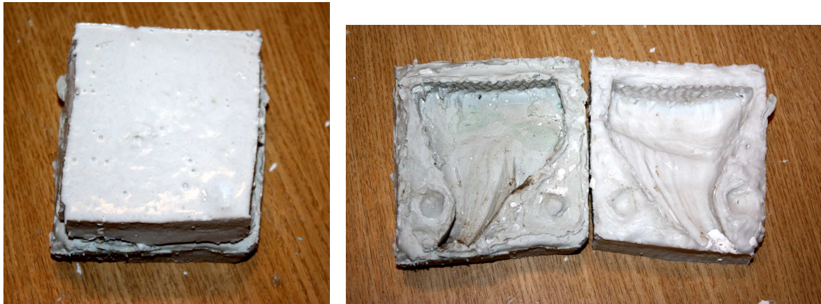
Egy szilikongumi öntőminta „becsukva” és „kinyitva”.
